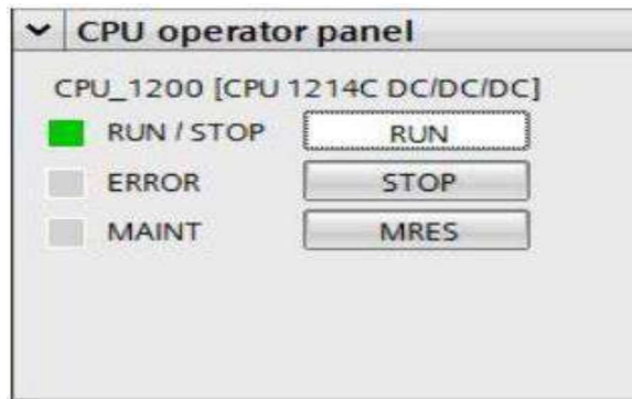
Figure 1.24: Mode STOP ou RUN et bouton MRES
